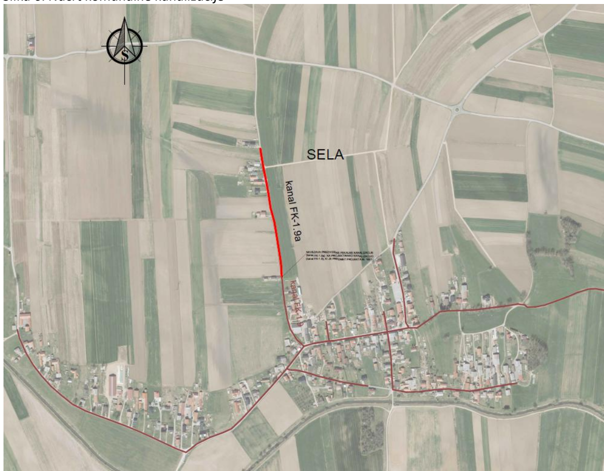
Slika 6: Načrt komunalne kanalizacije
